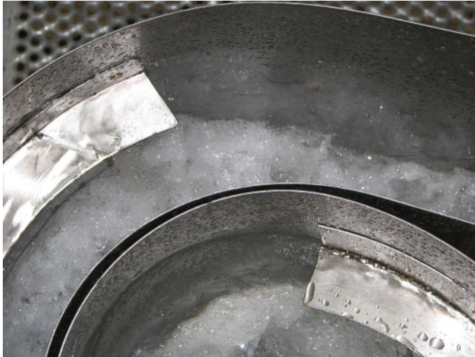
Bild 5: Blick in Einlaufspirale 1 (oberer Teil) und Einlaufspirale 2 (unterer Teil) mit Strahlführungen
