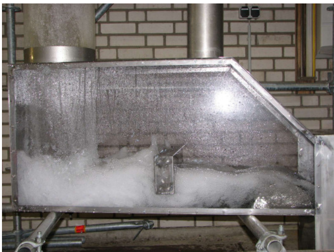
Bild 8: Toskammer wie in Bild 8 bei 50 % des Bemessungsdurchflusses
