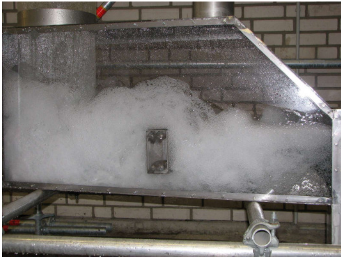
Bild 7: Fließverhältnisse in der Toskammer bei einer Sohlenhöhe von 252,15 m +NN, deutlicher Rückstau bei Bemessungsdurchfluss zur Förderung des Luftaustrags
